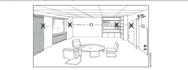
en Overview - Mount directly on a wall (A) or a conduit box (B).
